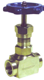
fig 521 naaldventiel staal PN210 1/4" - 1" bsp ANSI 3000 lbs huis : staal A105 teflon spindelafdichting naald : RVS 316 temp. : -20°C/+250°C
