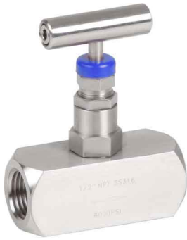
fig 522 naaldventiel RVS PN420 1/4" - 1" bsp ANSI 6000 lbs huis : RVS 316 teflon spindelafdichting
