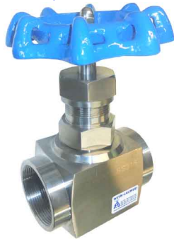
fig 523 naaldventiel RVS PN210 1/4" - 2" bsp ANSI 3000 lbs huis : RVS 316 teflon spindelafdichting
