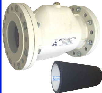
fig 686 mofafsluiter aluminium DN 40 - DN 200 huis : aluminium mof : natuurrubber flenzen volgens PN10 max. werkdruk 6 bar stuurdruk : = werkdruk + 2 bar temp. : max. +80°C voedingsgeschikte rubber op aanvraag
