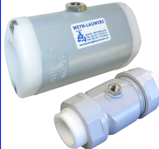
fig 685 mofafsluiter aluminium 1/2" - 2" bsp huis : aluminium / aansluitingen : POM mof : natuurrubber max. werkdruk 6 bar stuurdruk : = werkdruk + 2 bar temp. : max. +80°C voedingsgeschikte rubber op aanvraag
