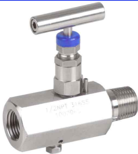
fig 525 naaldventiel RVS PN420 MF 1/4" en 1/2" bsp ANSI 6000 lbs huis : RVS 316 teflon spindelafdichting voorzien van aflaatopening temp. : -54°C/+250°C geschikt als manometerkraan
